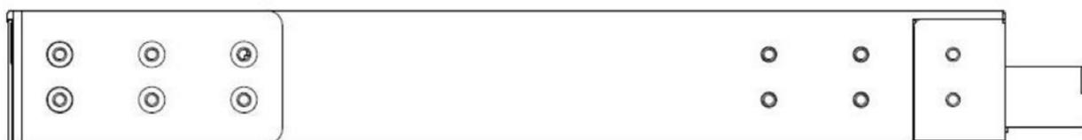
**Примечание:** Две дополнительные петли для крепления шасси коммутатора в стойку являются опциональными. Используйте их для обеспечения защиты задней части коммутатора в условиях повышенной вибрации.
